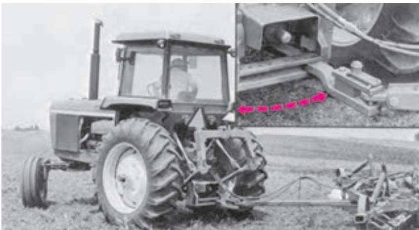
ب) هنگام کار با ادوات سنگین مایلند باید در وضعیت متحرک و هنگام جابه جایی در وضعیت ثابت قرار گیرد.
