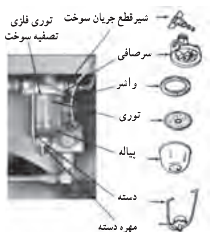
شکل ۱۳-۴ پیاله رسوب گیر زیر مخزن سوخت
