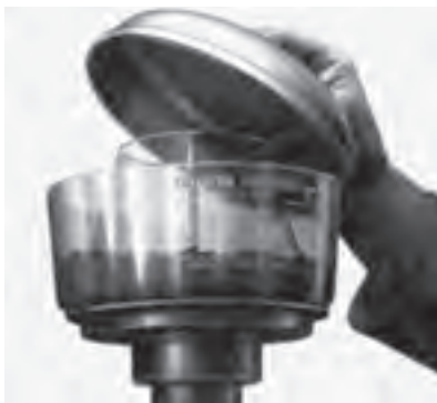
شکل ۲-۴- پیش صافی و تمیز کردن آن
