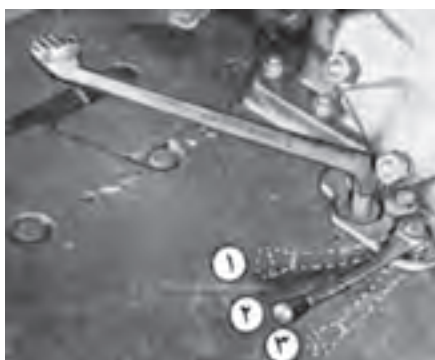
وضعیت (۱) موتور گرد، وضعیت (۲) خلاص، وضعیت (۳) چرخ گرد شکل ۲-۷- اهرم محور انتقال نیرو در تراکتور U65^{\circ}M
