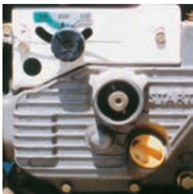
شکل ۹-۱۴- اهرم گاز در حالت استارت
