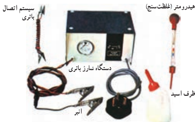
شکل ۴۴-۴- برخی از وسایل شارژ باتری
