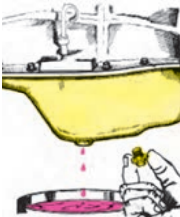
شکل ۳۳-۴- تخلیه روغن موتور
