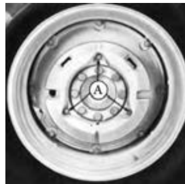
شکل ۱۹-۸ - وزنه اول در چرخ عقب تراکتور
