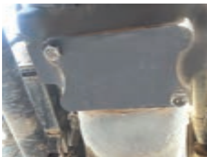
شکل ۱۱-۵- درپوش زیر پوسته کلاچ
