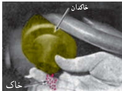
شکل ۷-۴- تمیز کردن خاکدان
