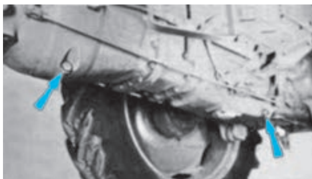
شکل ۳-۶ پیچ‌های تخلیه روغن هیدرولیک تراکتور MF ۲۸۵
