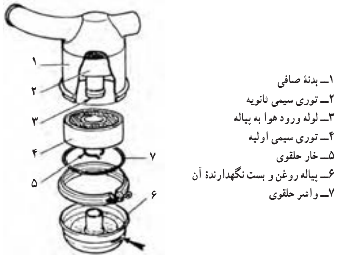
شکل ۳-۴ اجزای صافی هوا نوع روغنی
