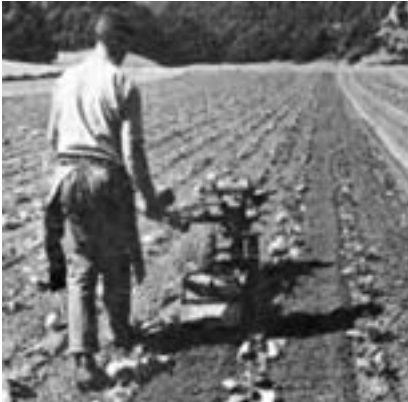
شکل ۹-۱۲- یک تراکتور دو چرخ در حال نرم کردن سطح خاک. توجه کنید که فرمان را در حالت غیرمستقیم قرار داده‌اند تا پیشرفت کار بهتر دیده شود.
