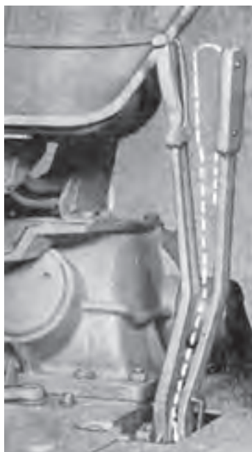
شکل ۲-۷- اهرم دیفرانسیل جلو (در تراکتور M ۶۵۰ U)
