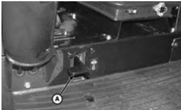
شکل ۱۴-۵- پدال قفل دیفرانسیل MF ۳۹۹
