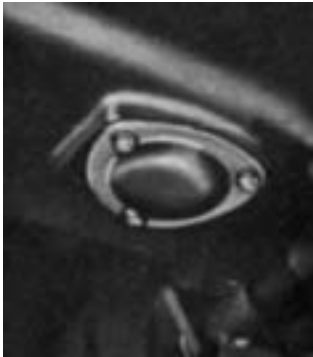
شکل ۲۶ - ۶- درب صافی روغن هیدرولیک تراکتور MF ۲۸۵
