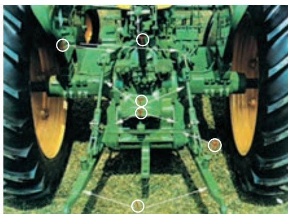
شکل ۳-۳ اجزای اتصال سه نقطه (در تراکتور JD ۳۱۴۰)
