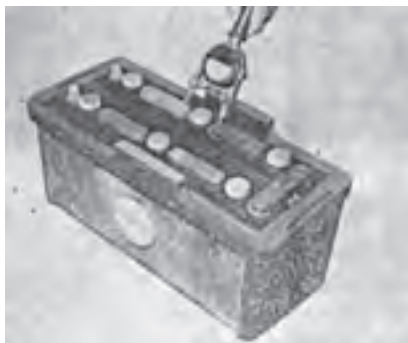
شکل ۴۶- آزمایش ولتاژ یک خانه باتری
