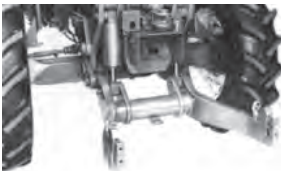
شکل ۲-۳ اتصال سه نقطه جلو (در تراکتور JD ۳۳۵۰)
