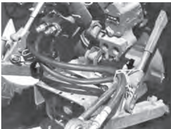
شکل ۱۳-۶- مهار نامناسب شیلنگ‌های هیدرولیک
